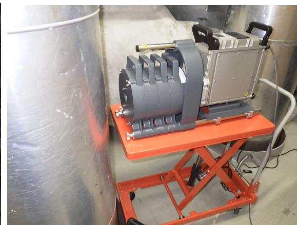
可搬型ゲルマ測定器による 配管付着放射能測定
