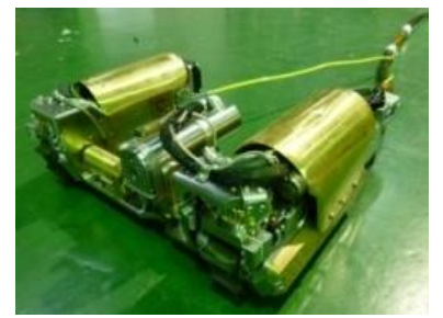
1号機格納容器調査に使用したロボット
