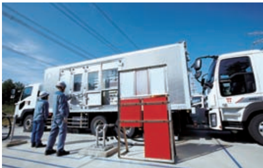
空冷式ガスタービン発電機車の起動訓練
