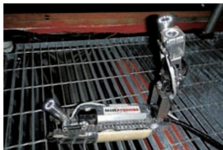
2号機格納容器の内部調査に使用した自走式調査装置
