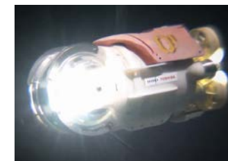
● 水中移動式調査ロボット/IRID(東芝)
