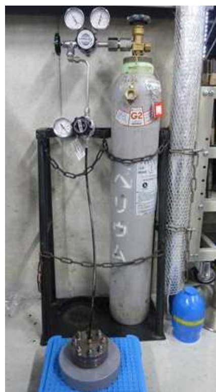
図 12 He 気密確認試験状況
