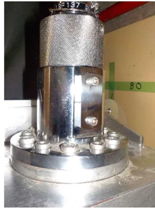
遠隔手動弁操作設備のリンク機構
