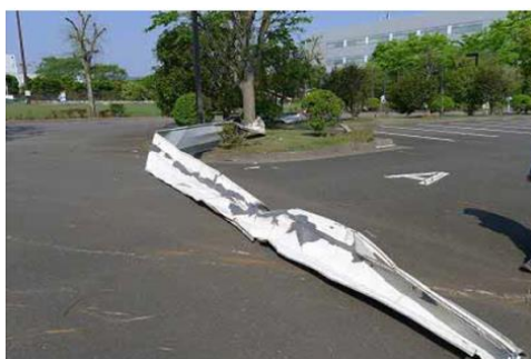
飛散した鋼板製屋根材
