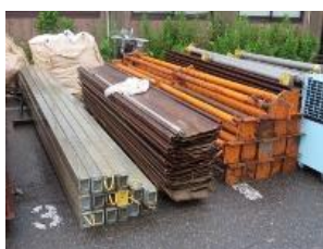
④-34 角型鋼管
