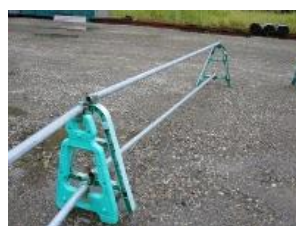
④-41 鋼製車止め (単管バリケード)
