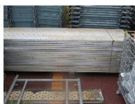
③-41 仮設足場板
