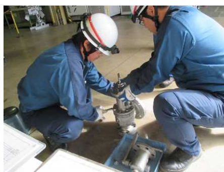
直営による安全弁の分解点検
