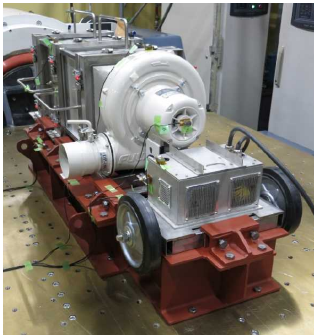
図4-3 5号炉原子炉建屋内緊急時対策所用可搬型陽圧化空調機 外観図
