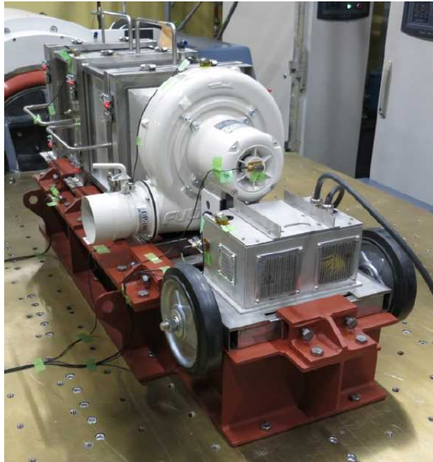
図 4-12 5号炉原子炉建屋内緊急時対策所用可搬型陽圧化空調機 外観図
