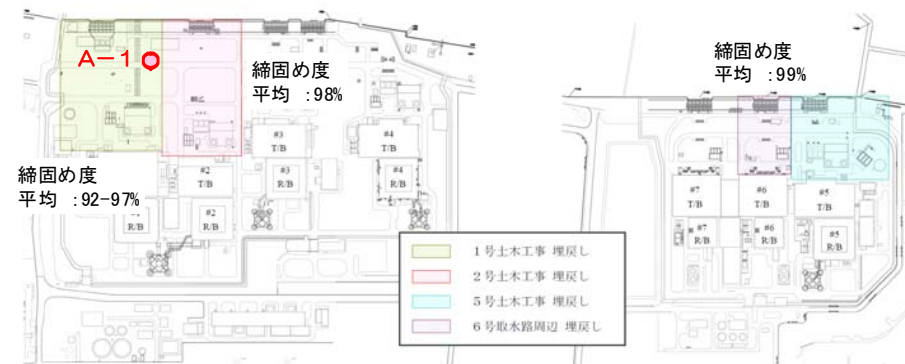
埋戻土の締固め度 (海側)
