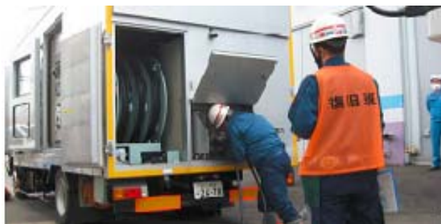
代替交流電源設備（ガスタービン発電機車、電源車）の接続訓練
