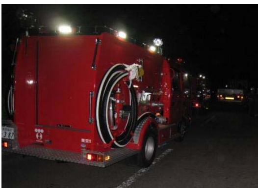
車両の作業用照明
