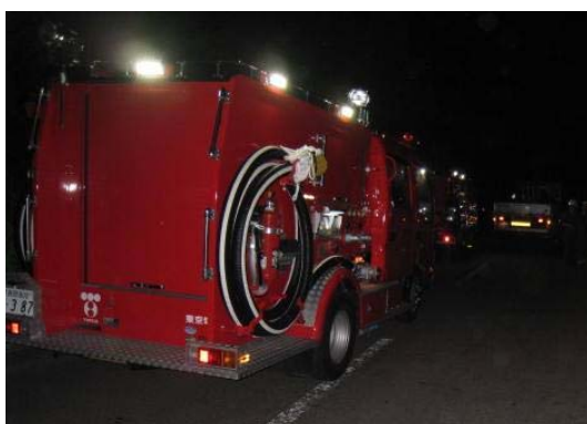
車両の作業用照明
