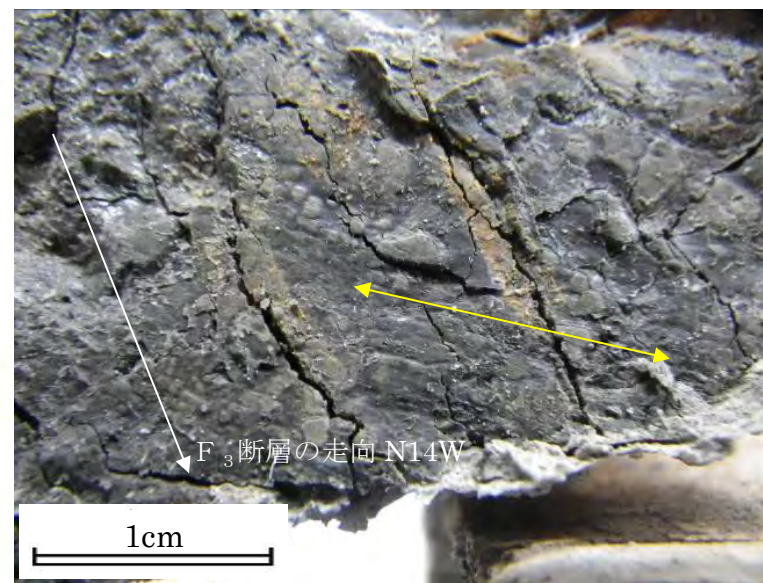
F 3 断層②の条線 (黄色矢印方向) 断層面の走向・傾斜: N58W18SW 条線のレイク角: 12L
