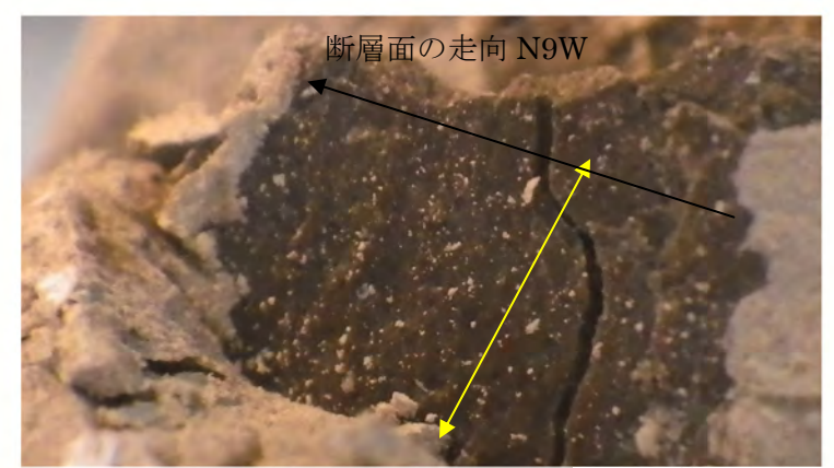
α 断層 (α 3) の条線 (黄色矢印方向) 断層面の走向・傾斜：N9W85W 条線のレイク角：80L
