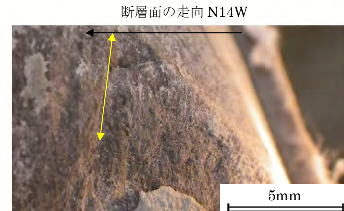
β 断層 (β 4) の条線 (黄色矢印方向) 断層面の走向・傾斜：N14W84E 条線のレイク角：83L
