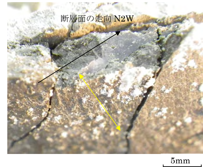
α 断層 (α 1) の条線 (黄色矢印方向) 断層面の走向・傾斜：N2W89E 条線のレイク角：87L (本面は下盤側から見ている)
