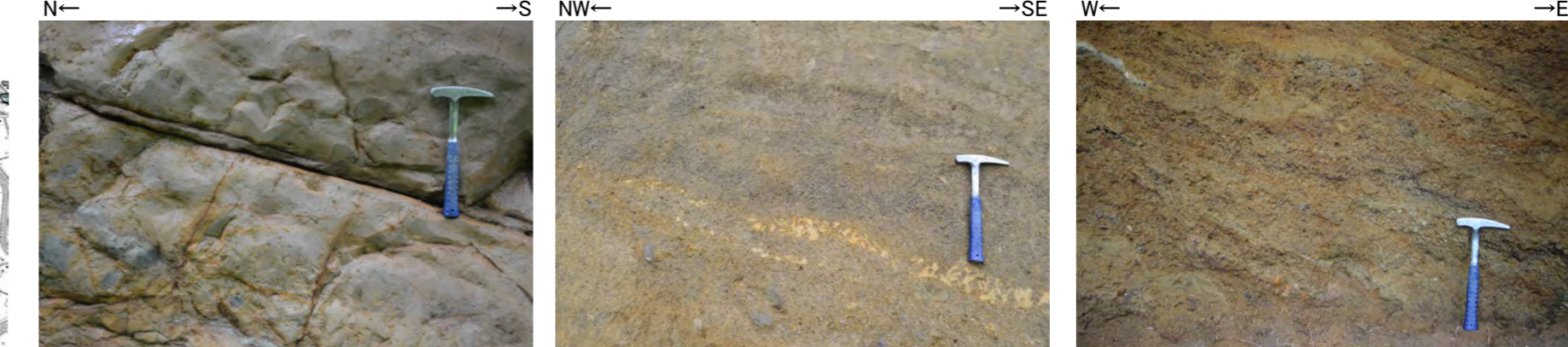
Loc. 1 灰爪層砂質泥岩，層理面の走向・傾斜はN61E,29Sを示す。 Loc. 2 和南津層砂岩，層理面の走向・傾斜はN55E,16SEを示す。 Loc. 3 魚沼層砂岩・礫岩互層，層理面の走向傾斜はN26E,24Eを示す。
