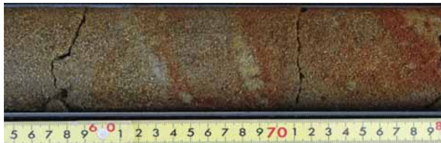
古安田層：シルト質中粒砂 (L1-3 孔 深度 32.55m 付近)
