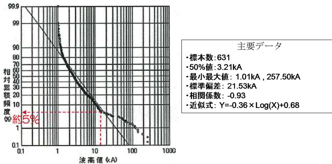
図 1-2 柏崎刈羽原子力発電所の雷観測に基づく雷撃電流累積頻度分布
