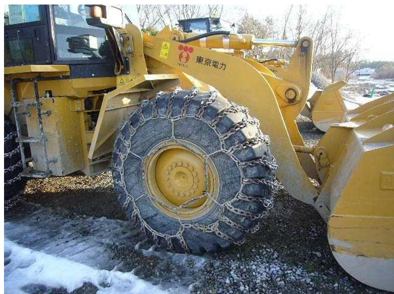
重機の凍結路面の滑り防止対策
