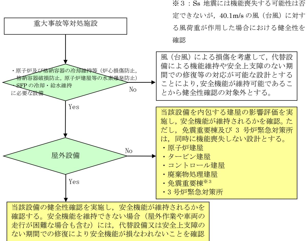
図 2 風（台風）に対する重大事故等対処施設の評価フロー
