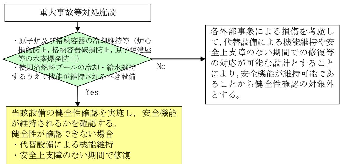
図 5 外部事象による重大事故等対処施設への評価フロー
