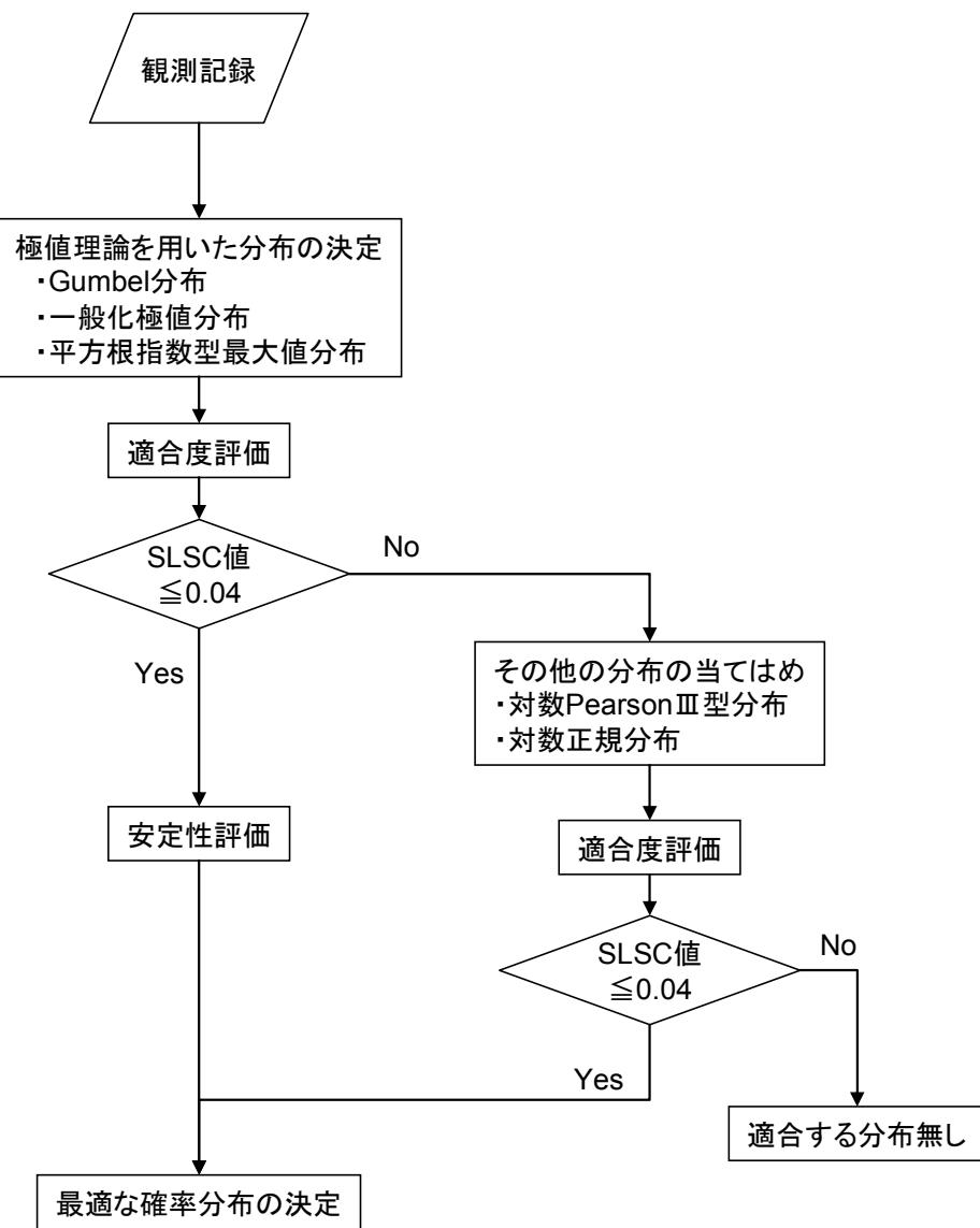
図3-1 年超過確率評価フロー
