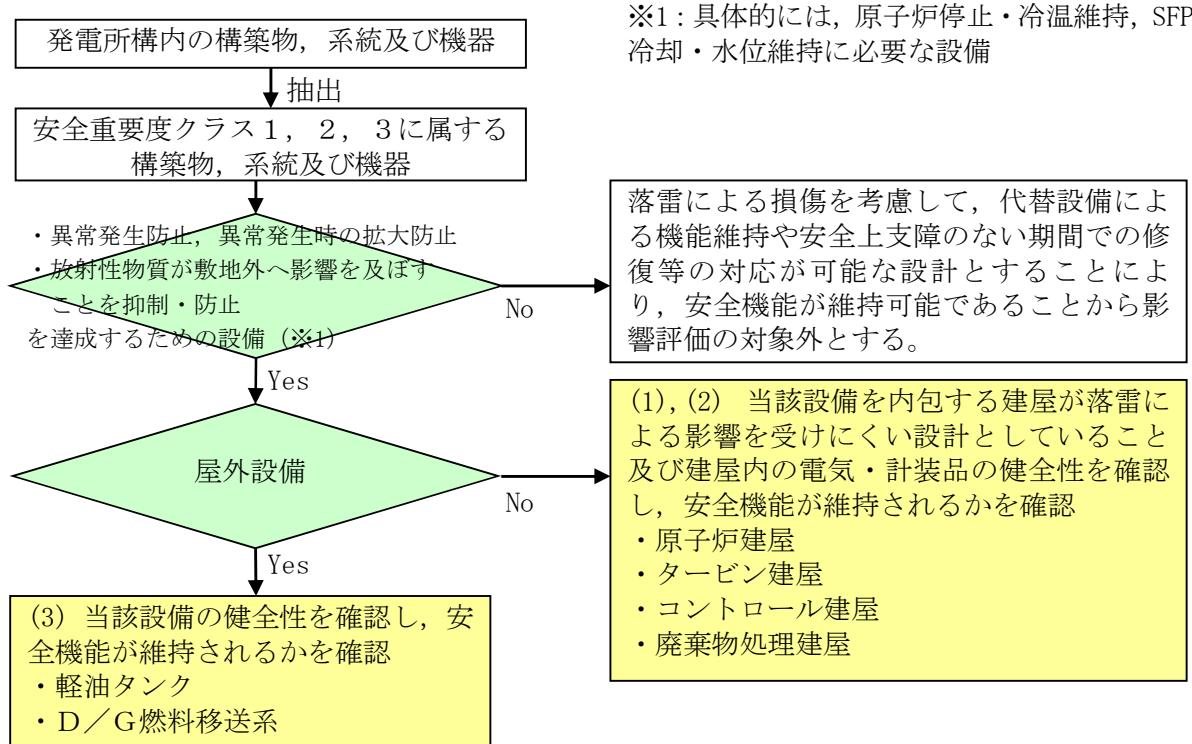
図1 落雷に対する安全施設の評価フロー
