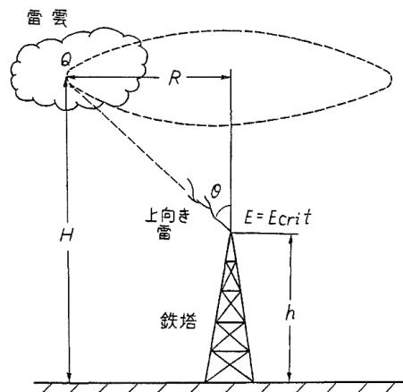
図 2-2 上向き雷の雷撃計算パラメータ
