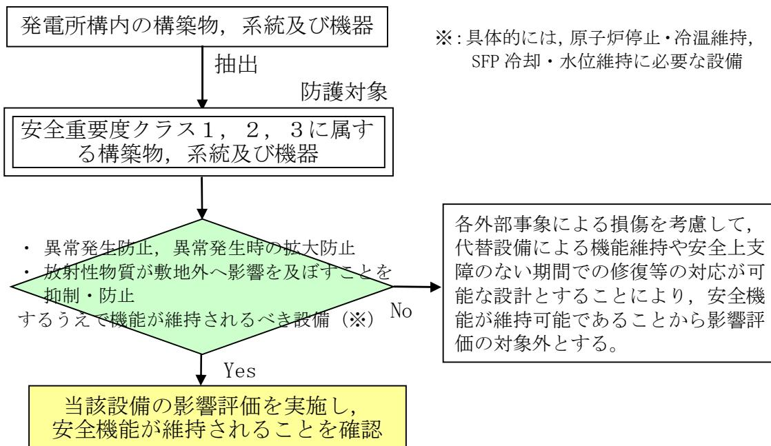
図 4 外部事象による安全施設への評価フロー
