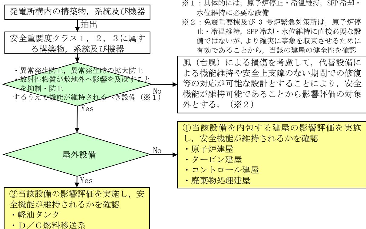
図1 風（台風）に対する安全施設の評価フロー
