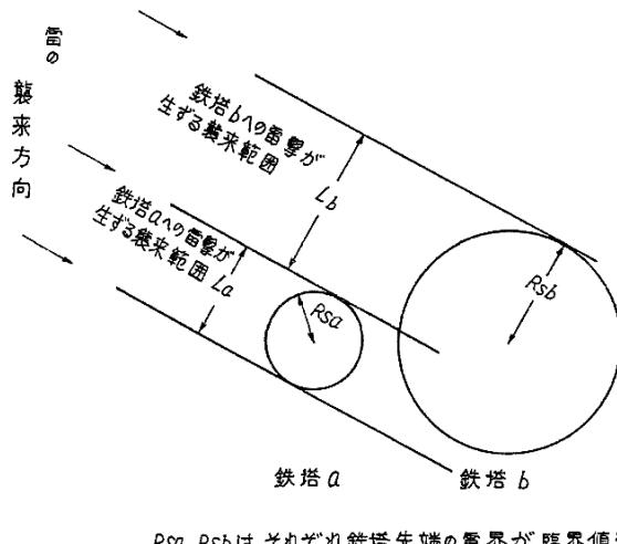
$R_{Sa}, R_{Sb}$ はそれぞれ鉄塔先端の電界が臨界値を超える雷雲電荷と鉄塔との距離
