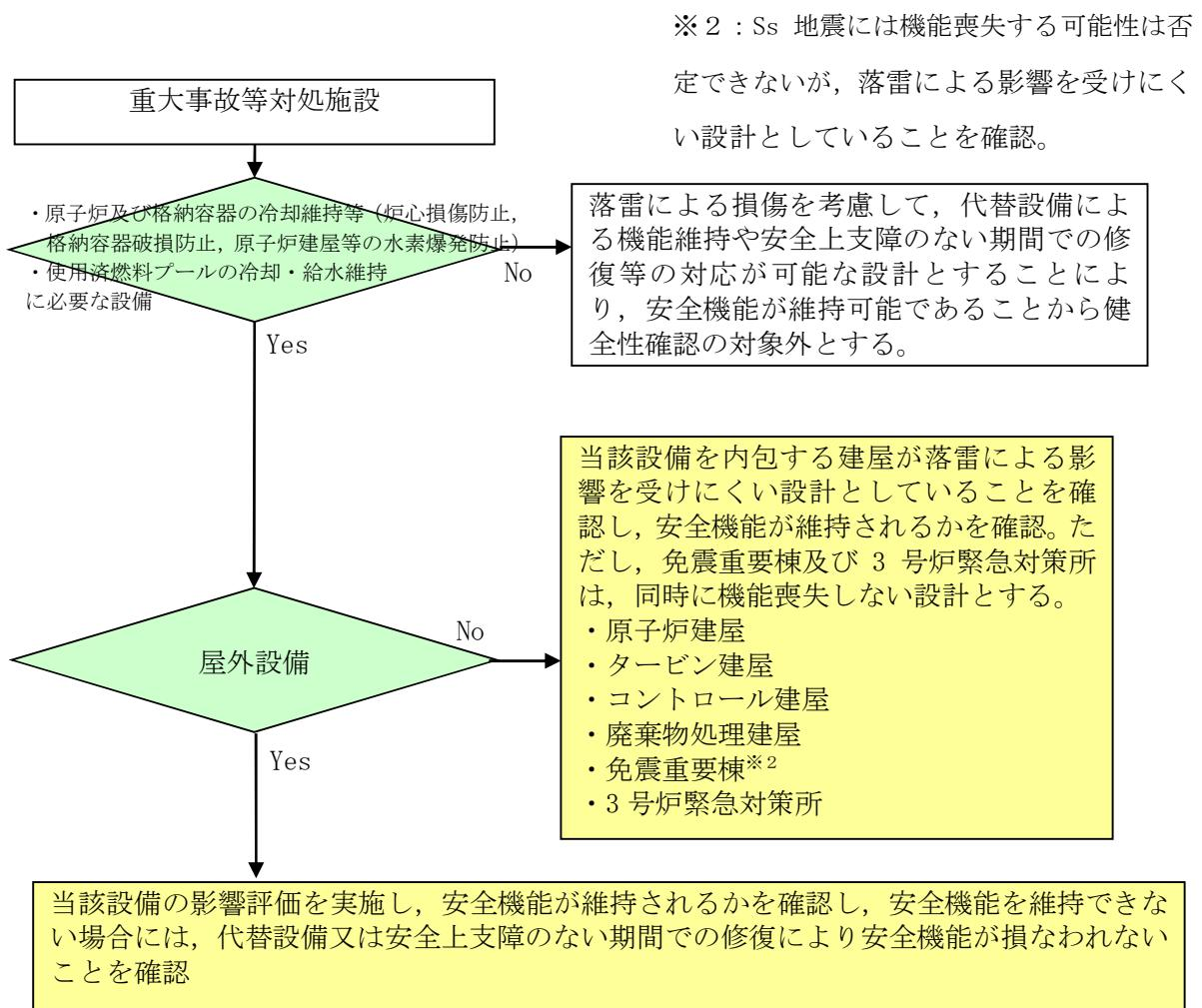
図2 落雷に対する重大事故等対処施設の評価フロー
