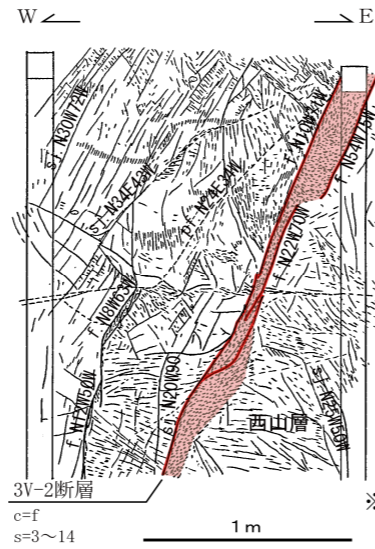
⑥3V-2 断層 (3号炉 B 坑北側壁)
