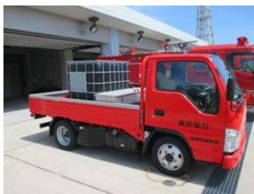
泡消火薬剤備蓄車
