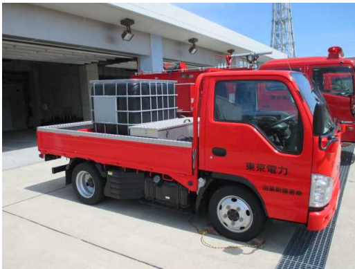
図2 泡消火薬剤備蓄車
