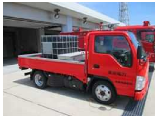
泡消火薬剤備蓄車
