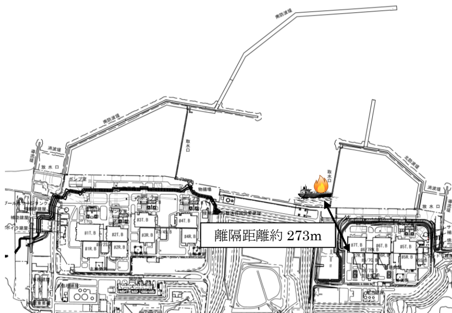
第 2.2.2.4-1 図 漂流船舶の離隔距離
