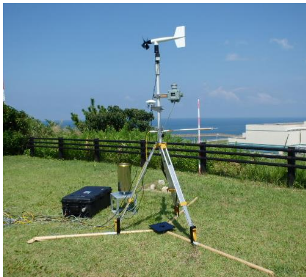
第 2.3-4 図 可搬型モニタリングポスト（左），可搬型気象観測装置（右）
