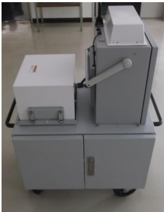
第 2.3-4 図 可搬型モニタリングポスト（左），可搬型気象観測装置（右）
