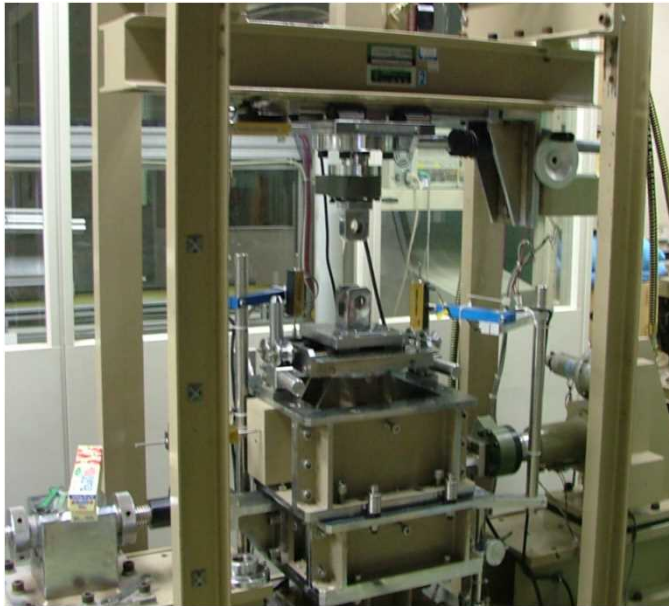
要素試験 (地中外壁摩擦試験)
