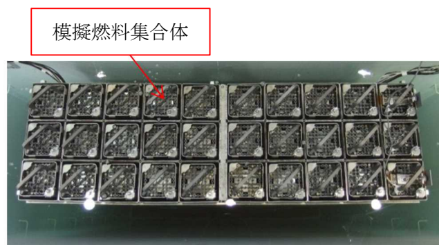
(2) 供試体の水槽内設置状況
