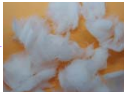
木道パルプ。取り出した繊維から脱水と 漂白を繰り返して作られる
