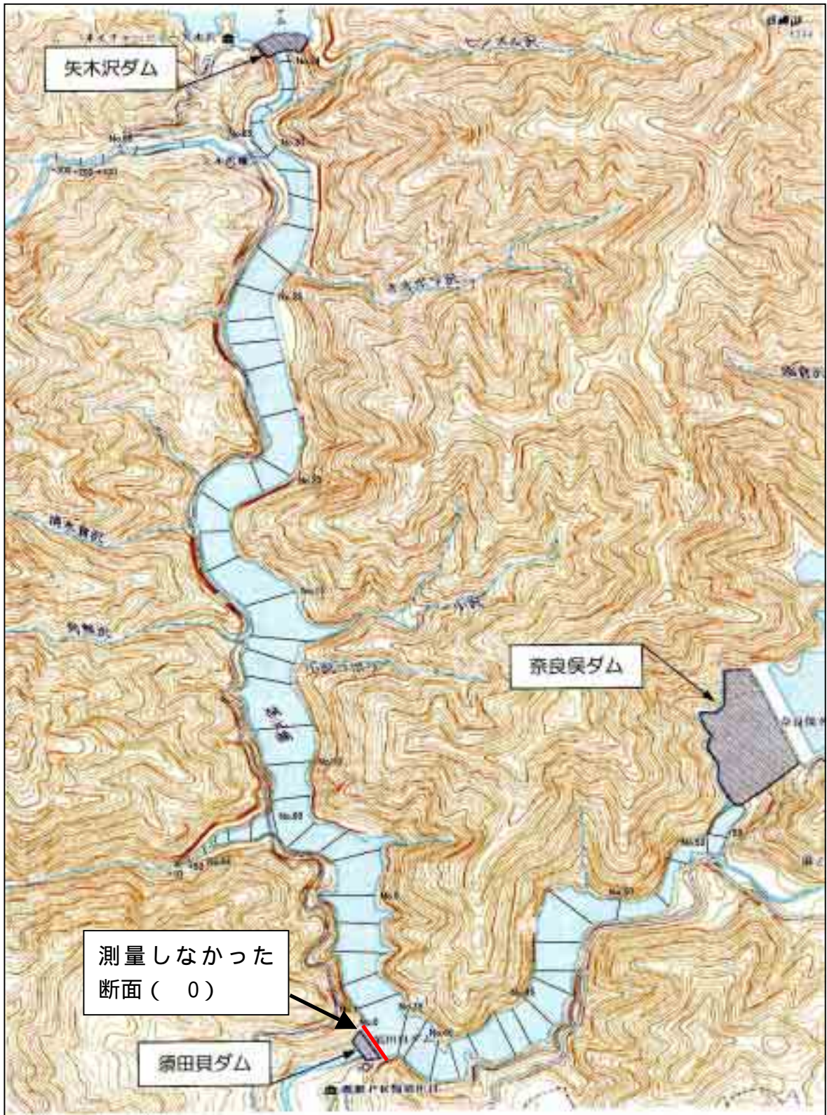
図 - 10 須田貝貯水池の測量断面図
