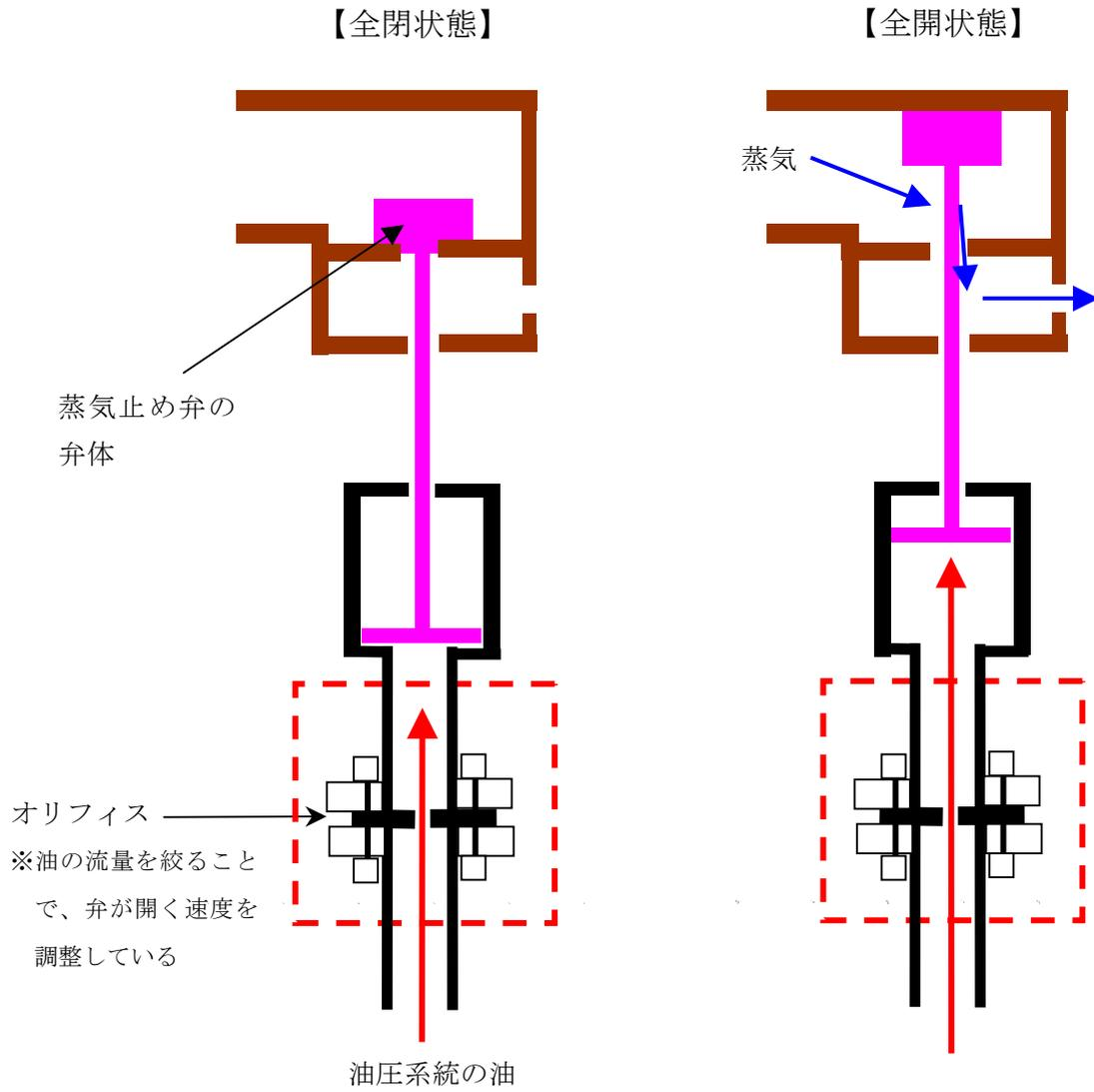
高压注水系の蒸気止め弁の構造概要図
