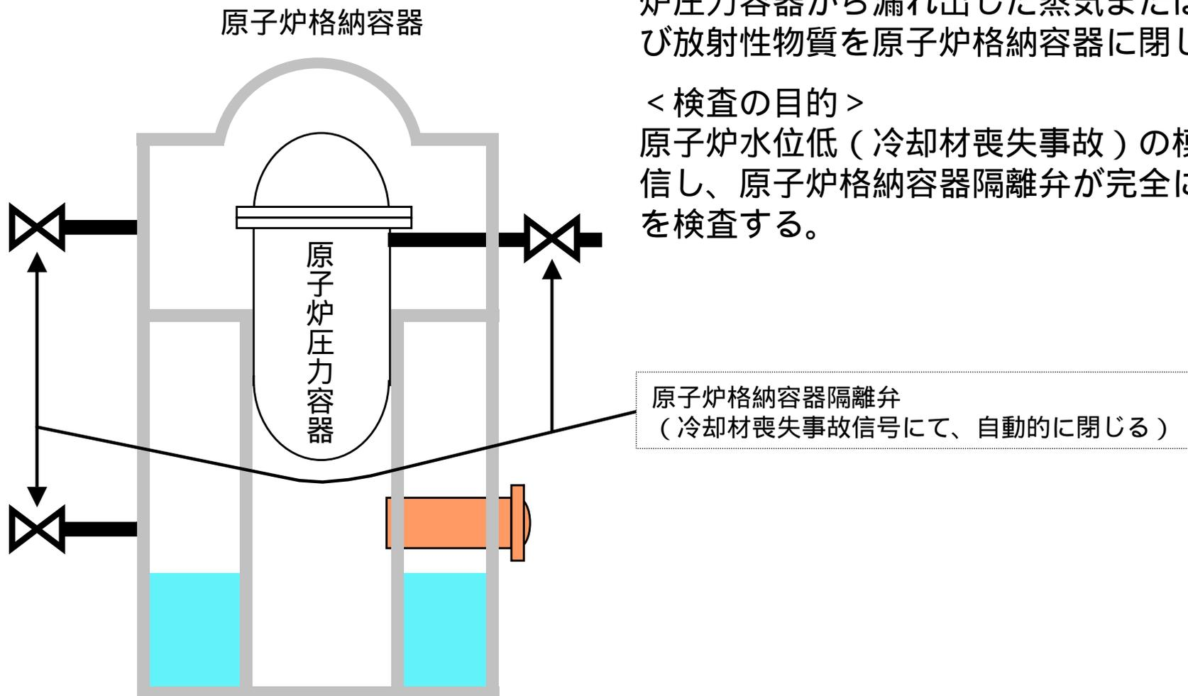
柏崎刈羽原子力発電所 7号機 系統機能試験実施状況(1/2)
