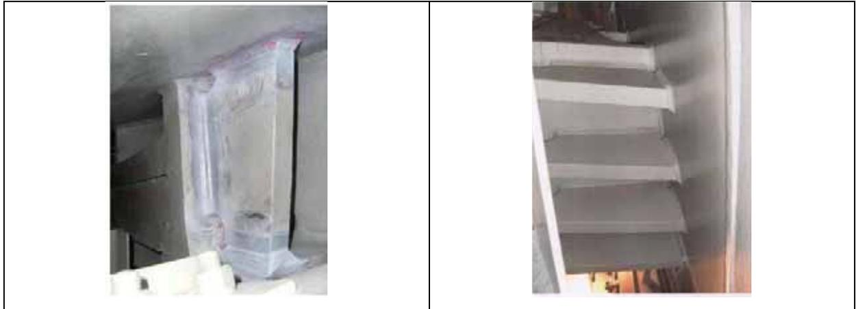
図 A3-2-2-5 浸透探傷試験結果
