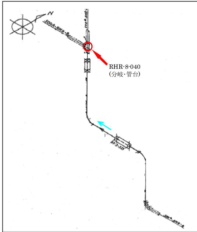
图 3-3 配管板厚測定箇所（残留熱除去系）
