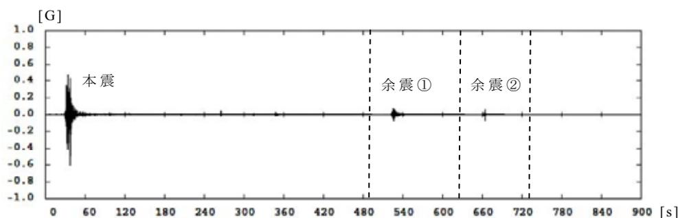
図1 加速度時刻歴の比較例（原子炉建屋中間階，NS方向）
