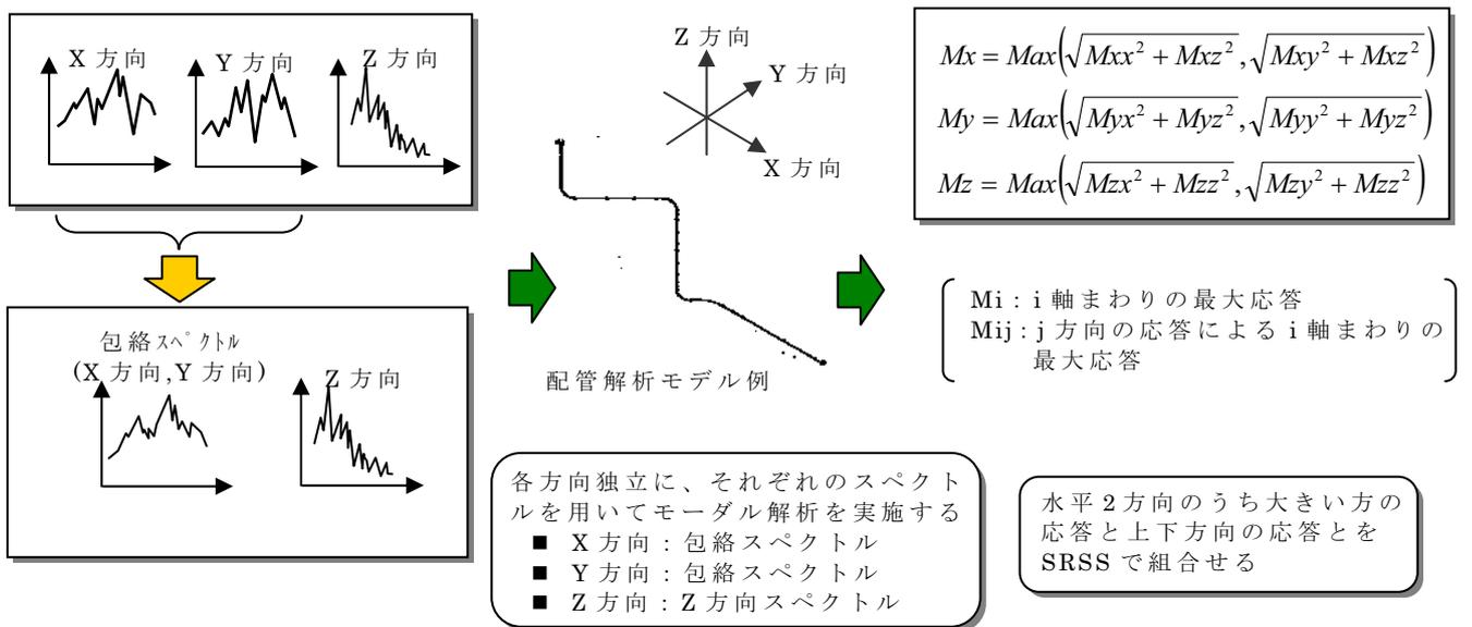
図 2 スペクトルモーダル解析の概要
