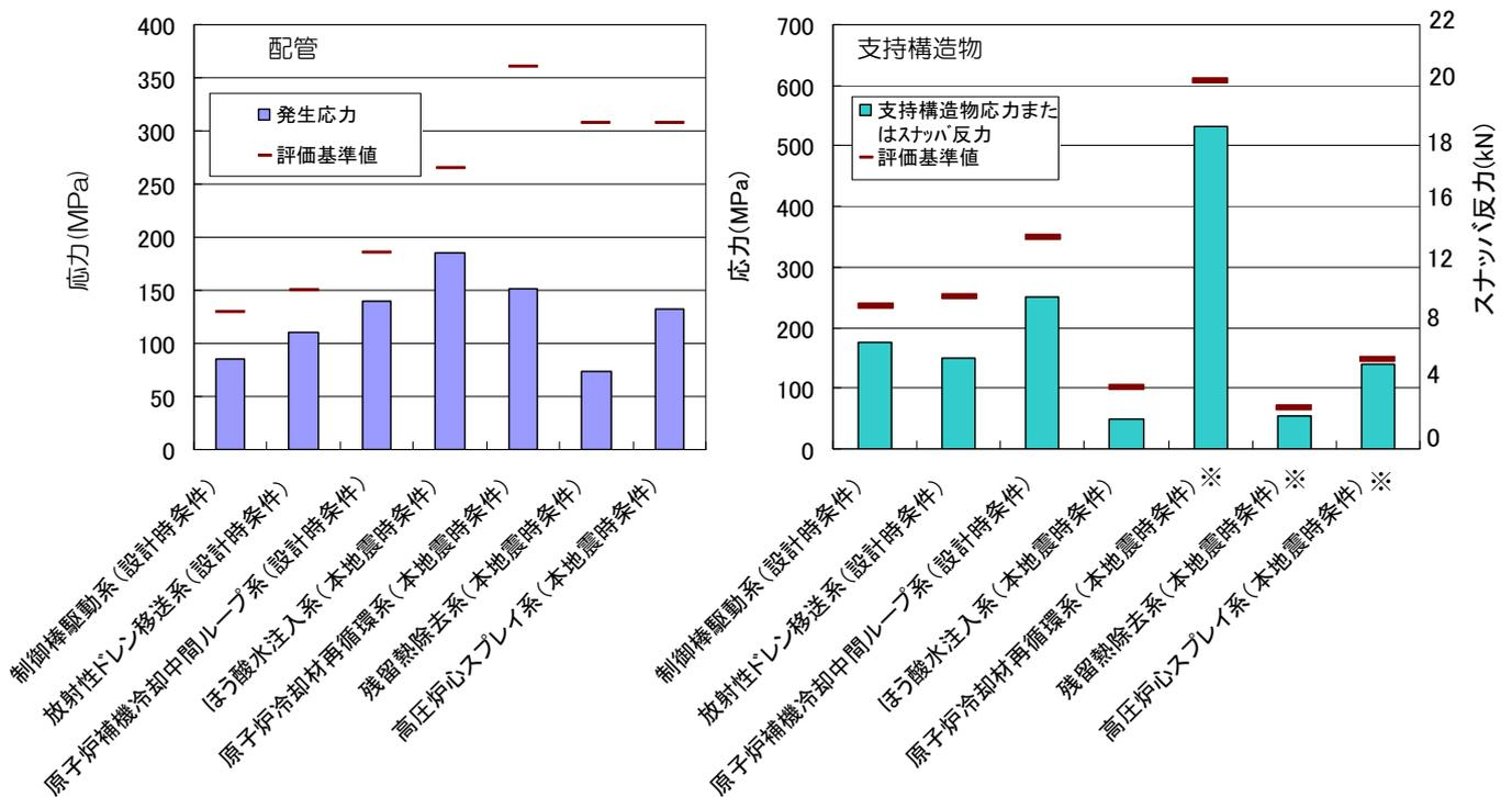
※ 原子炉冷却材再循環系, 残留熱除去系, 高圧炉心スプレイ系の支持構造物(スナッパ)は、左の軸で示す。単位 MPa は kN に読み替える。
