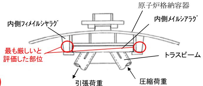
図 A3-2-2-2 上部シヤラグの概略及び評価部位
