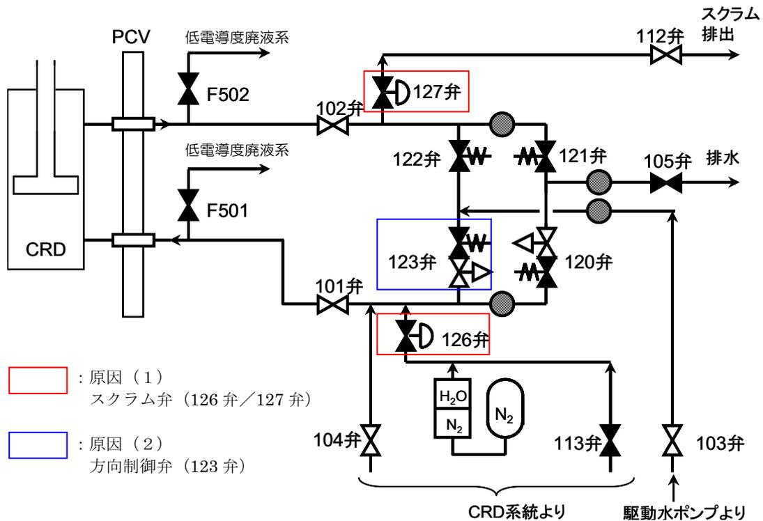
図-2 制御棒駆動系概略系統図
