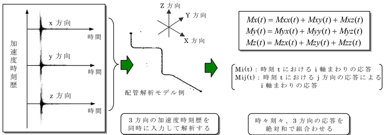
図 1 3 方向同時時刻歴解析の概要
