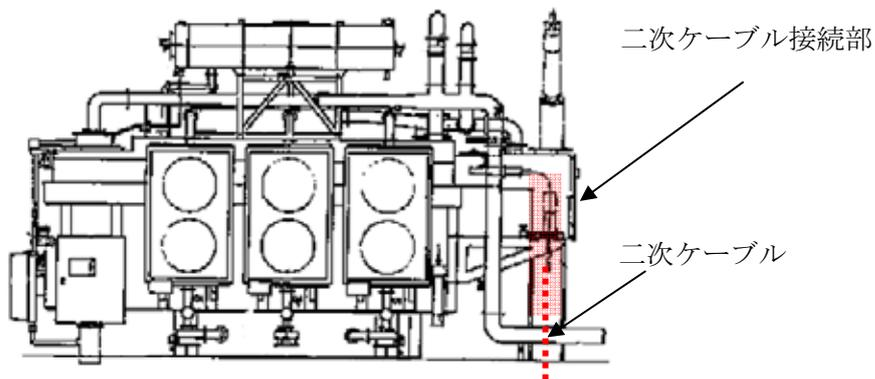
図 1 (b) 予備変圧器側面外形図
