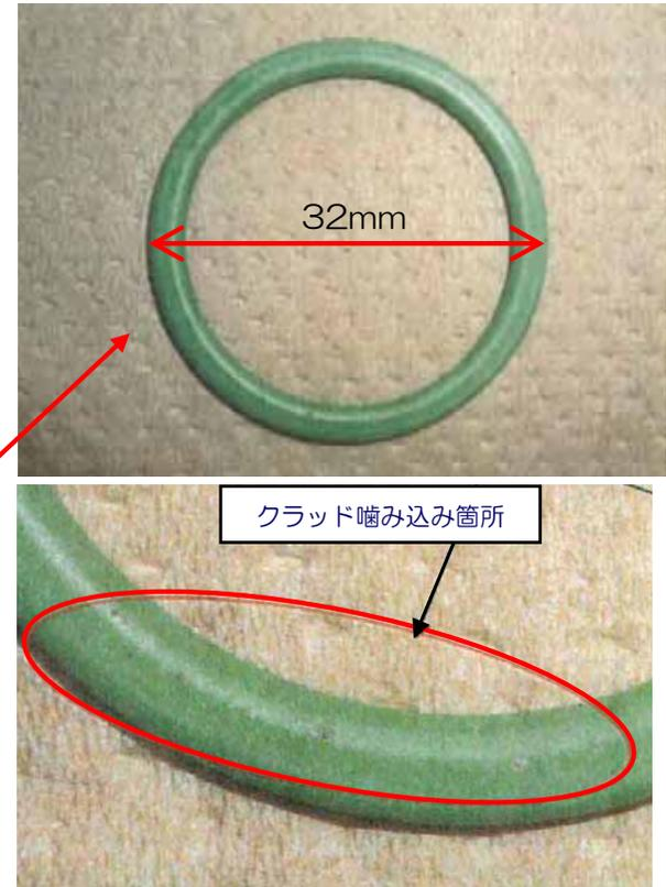
制御棒駆動機構フランジ部Oリング点検結果
