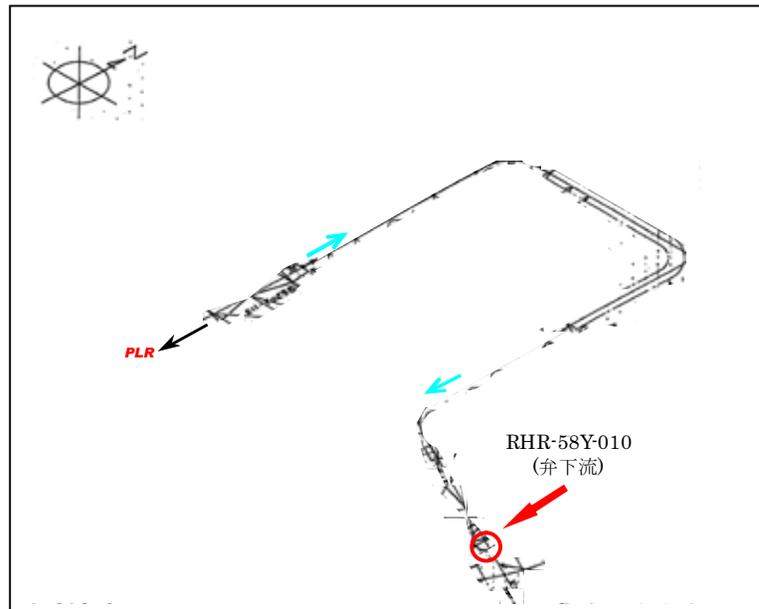
図 3-1 配管板厚測定箇所（残留熱除去系）
