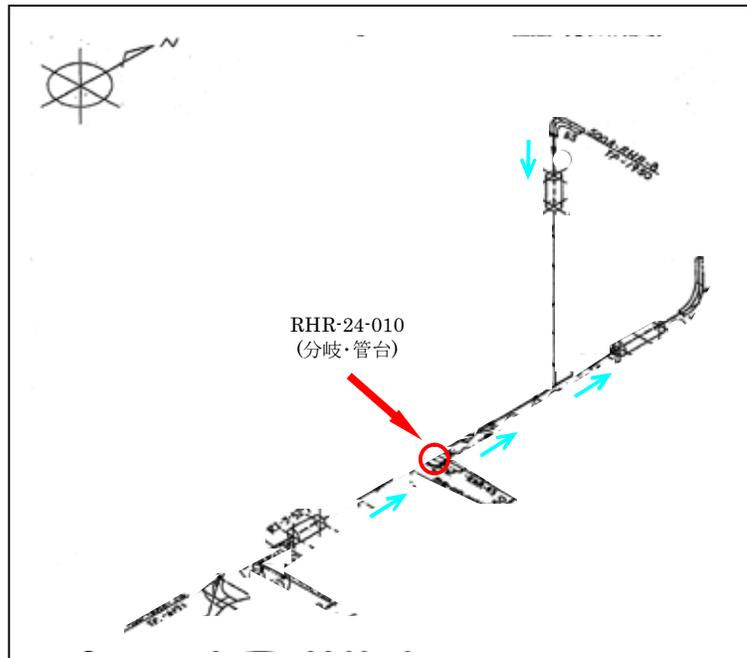
図 3-5 配管板厚測定箇所（残留熱除去系）
