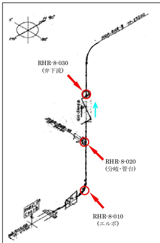
図 3-2 配管板厚測定箇所（残留熱除去系）
