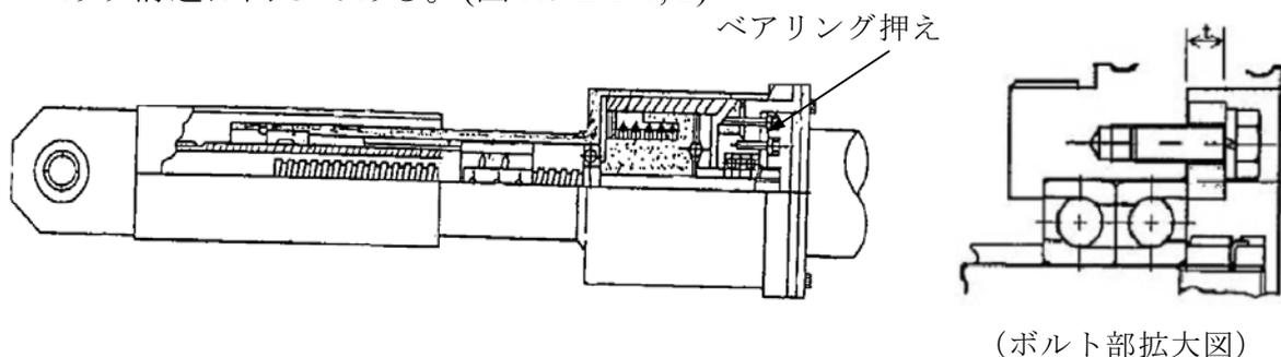
図 A3-2-1-1. メカニカルスナップ A, B の構造概略図
