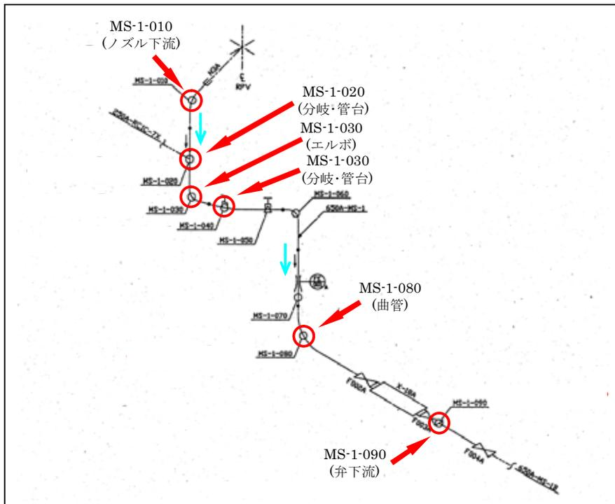
図 1-1 配管板厚測定箇所（主蒸気系）
