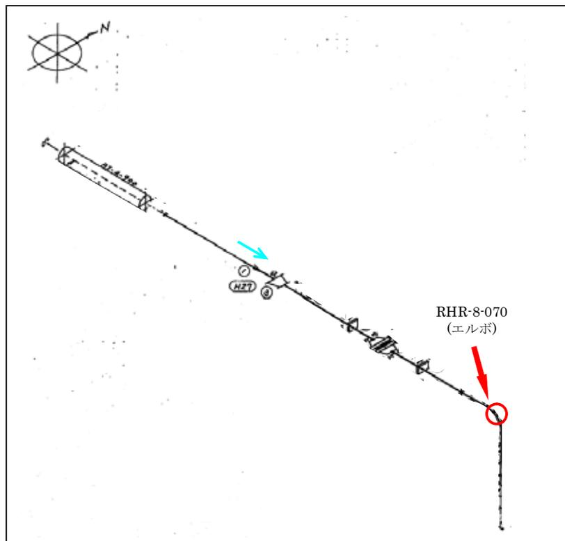
図 3-6 配管板厚測定箇所（残留熱除去系）
