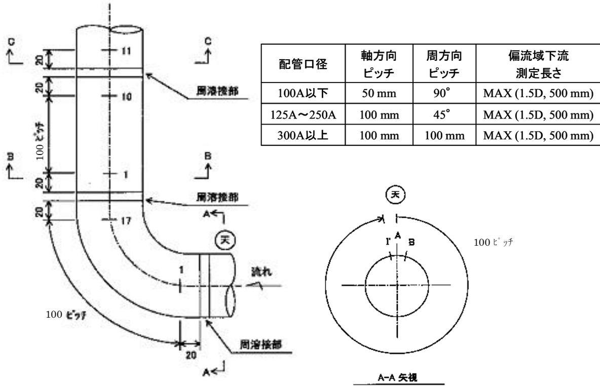
図4 配管板厚測定点の設定例
