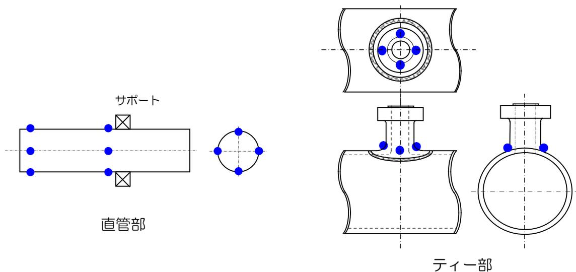
図-2 各部位の硬さ測定箇所（基本方針）
