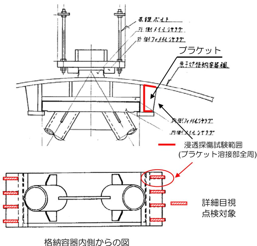
図 A3-2-2-4 内側メイルシヤラグの点検部位および点検方法
