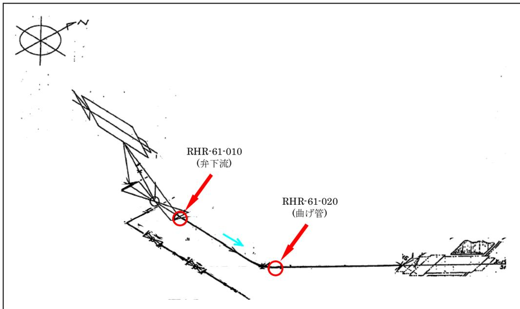
図 3-8 配管板厚測定箇所（残留熱除去系）
