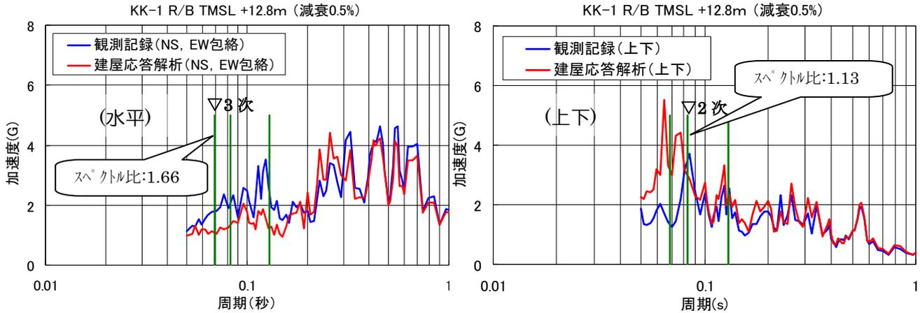
図 A2-2-10. 残留熱除去系配管（本地震時条件）の主要モードと原子炉建屋床応答スペクトル（減衰 0.5%）
