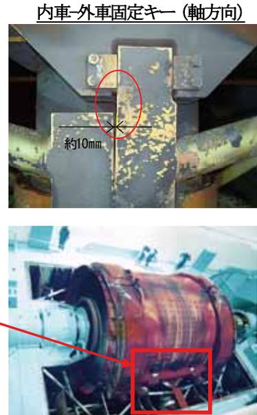
ジャーナル軸受及び軸受油切り、タービンロータ等の損傷
