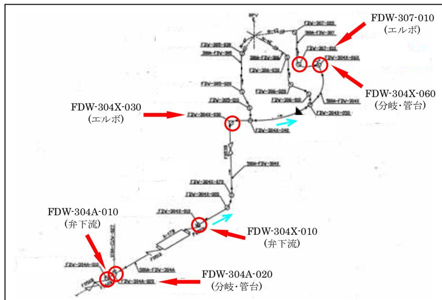
図 2-1 配管板厚測定箇所（給水系）
