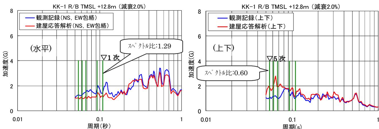
図 A2-2-7. 原子炉補機冷却中間ループ系配管（設計時条件）の主要モードと原子炉建屋床応答スペクトル（減衰 2.0%）
