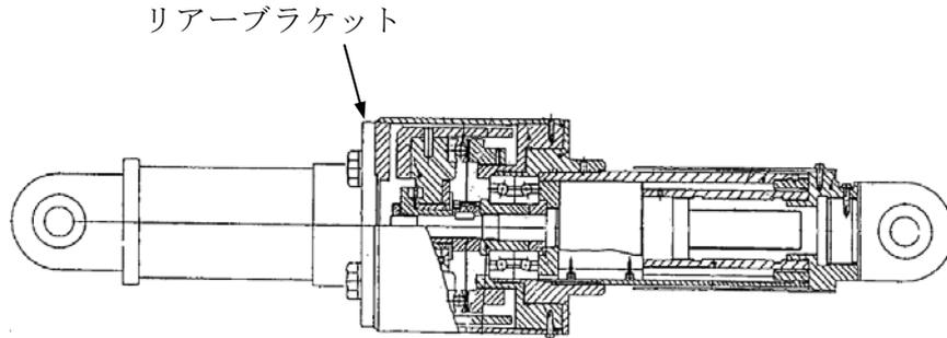
図 A3-2-1-2. メカニカルスナップ C, D の構造概略図
