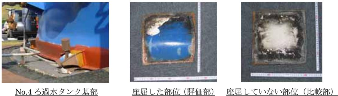
図-1 ろ過水タンク 試験サンプル状況
