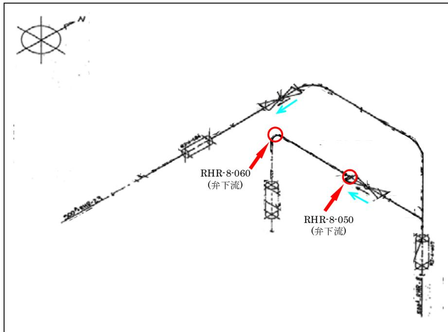
图 3-4 配管板厚測定箇所（残留熱除去系）
