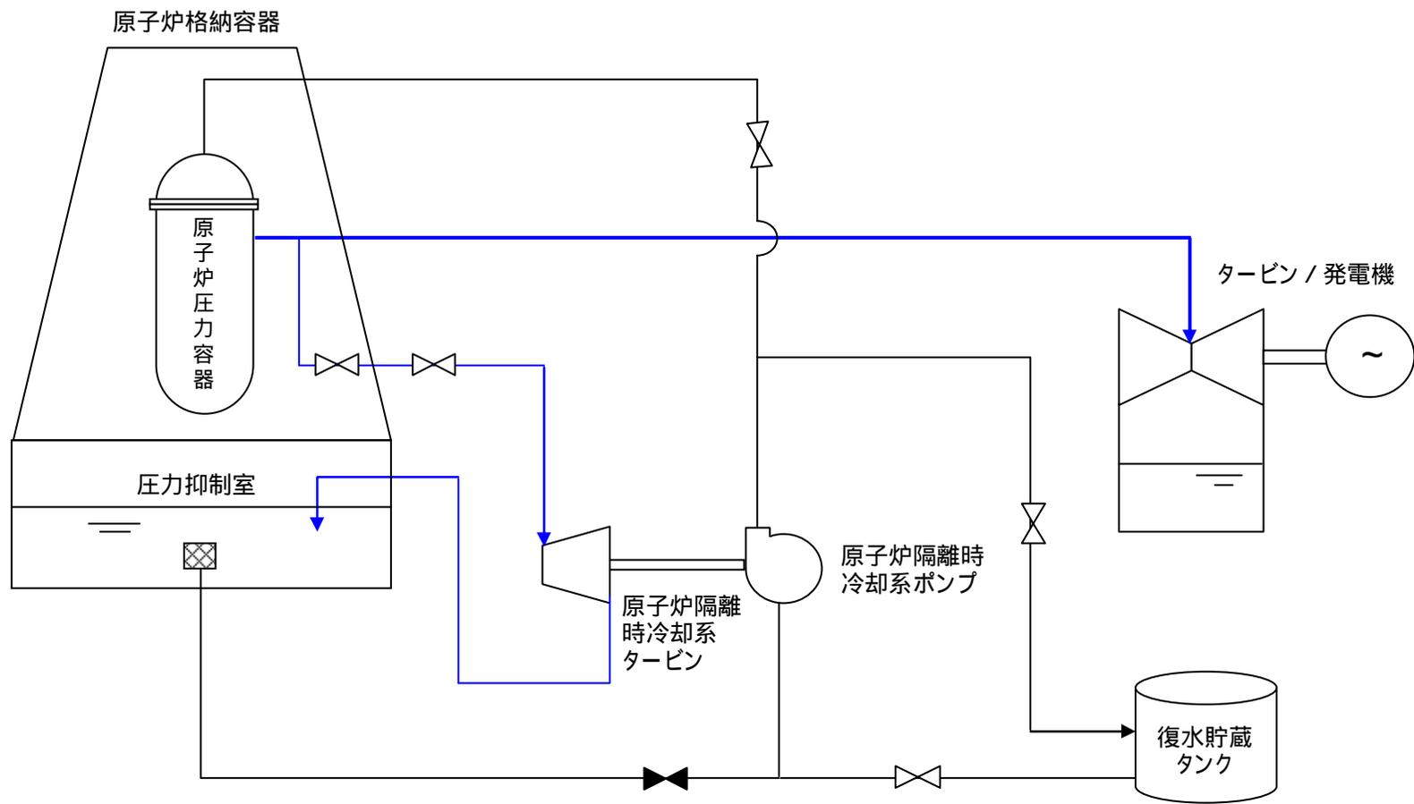
【参考】原子炉隔離時冷却系 系統概略図(110万kwの例)
