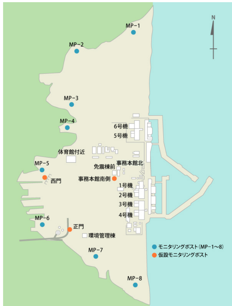
福島第一原子力発電所構内モニタリングポスト設置箇所
