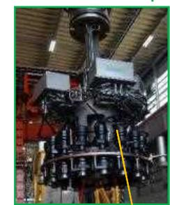
補巻先端に接続した構内用輸送容器蓋締付装置で蓋を締める
