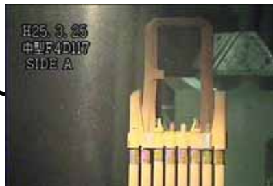
上部タイプレート、被覆管 変形・損傷無し
