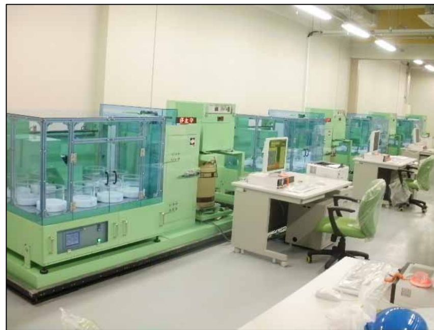
新分析室（地下1階）における Ge半導体検出器の配備状況
