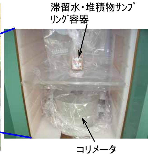
滞留水・堆積物サンプリング容器および測定コリメータ設置状況
