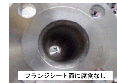
スラリー移送ポンプ出口配管フランジ
