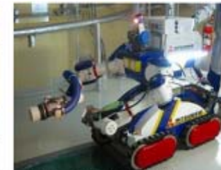
吸引・ブラスト除染装置 (三菱重工)
