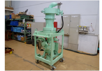
サイクロンセパレータ付 ブラスト機
