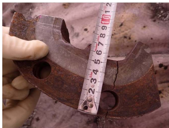
切断後のフランジ面
