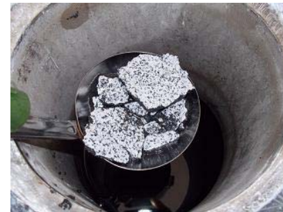
吸着塔1塔目上部堆積物
