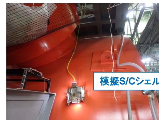
S/C下部外面調査装置工場試験
