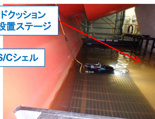
サンドクッションドレン管調査装置工場試験
