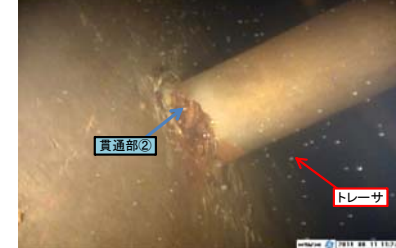
〈調査カメラ映像〉貫通部②トレーサ投入による流れの確認
