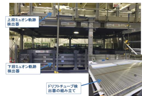
図5 散乱法ミュオン軌跡検出器のシステム試験の組み立て状況
