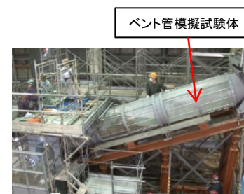
図2 ベント管止水用止水材試験状況
