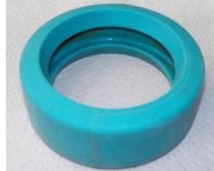
② 配管継手ゴムリング目視点検状況 (傷、変形、摩耗等の異常なし)
