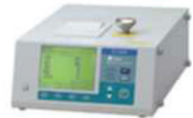
測定範囲: 10 \mu\text{m} ~ 100 \mu\text{m} KC-20A(リオン製)
