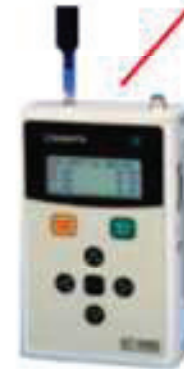
測定範囲: 0.3 \mu\text{m} ~ 10 \mu\text{m} GT-526S型(柴田科学製)
