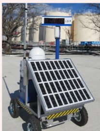
線量率モニタの設置状況
