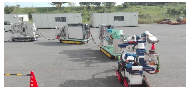
図2 上部階用除染装置
