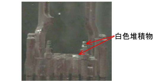
図1 共用プール内の燃料集合体白色堆積物が確認された
