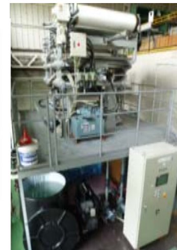
図2 スラリーの脱水処理を検討するための加圧ろ過試験装置
