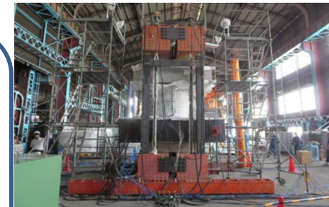
図3 RPVペダスタルの耐力評価試験(縮小模型試験体)
