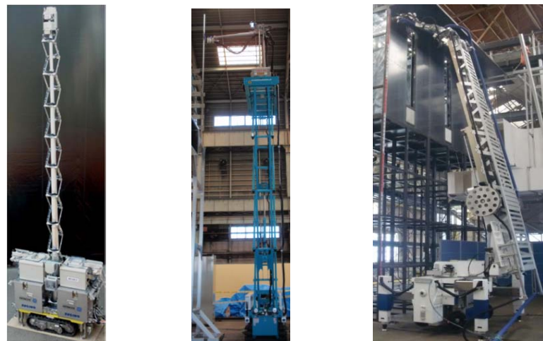
高圧水ジェット ドライアイスプラスト 吸引・プラスト 図1 高所用除染装置
