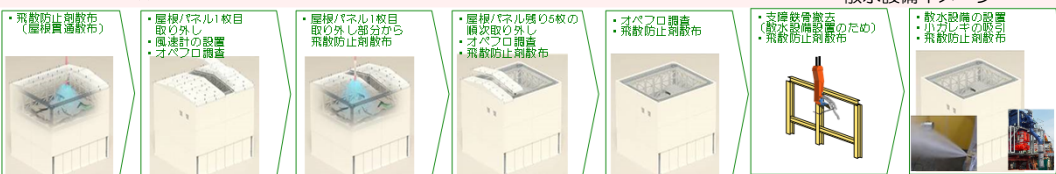
建屋カバー解体の流れ（至近の工程）
