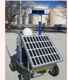
線量率モニタの設置状況
