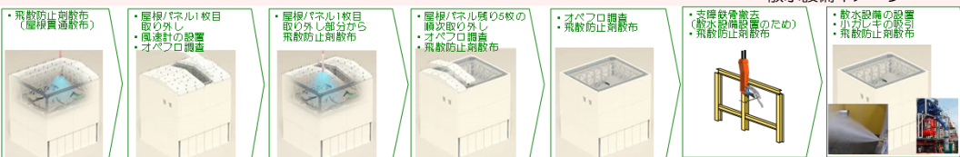
建屋カバー解体の流れ（至近の工程）
