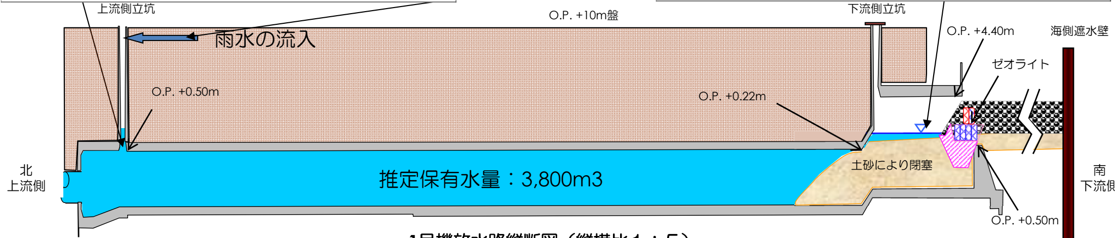
1号機放水路縦断図（縦横比1：5）
