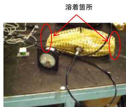
円筒シートの気密試験
