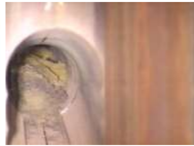
写真 C 燃料デブリの例 (ウインズケール)
