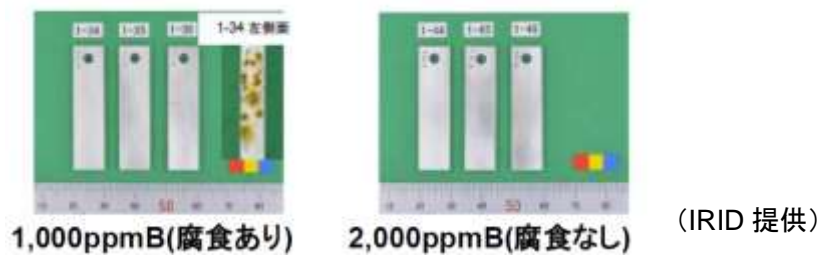
図 4.3.2-4 五ホウ酸ナトリウムによる鋼材腐食試験結果 (1000 倍海水、100 時間)
