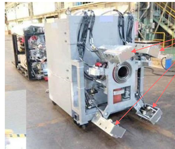
隔離機構ユニットの製作状況
