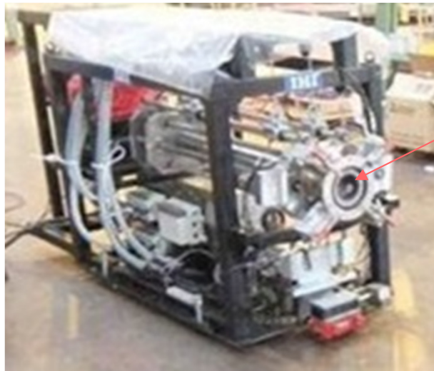
穴あけ装置の製作状況
